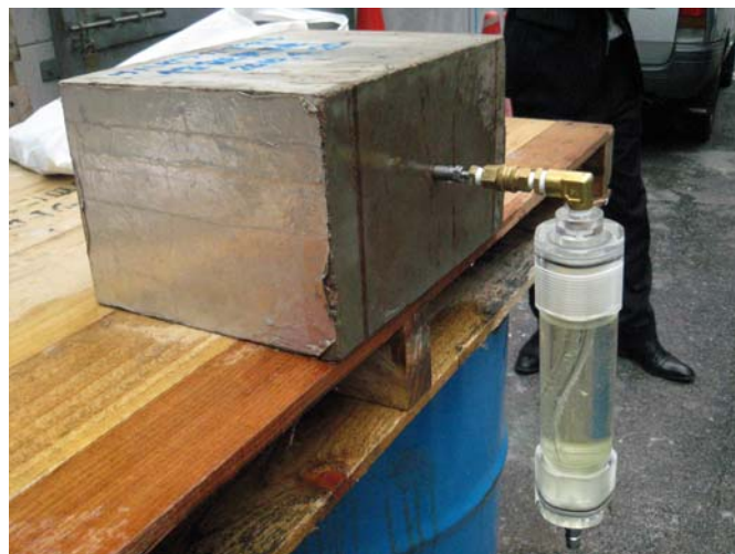
図 1 亜硝酸イオン内部圧入工法の供試体実験状況(カプセルタイプ圧入装置)
