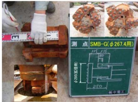
削孔ツールズ(拡張ビット:SMB-G)
