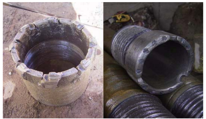
ビット破損状況
