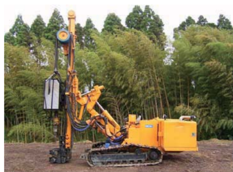
削孔機(ハンマー部防音シート養生)
