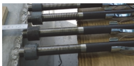
図－３ リングナット式 (PC 鋼棒 \phi 13 , \phi 17 )
