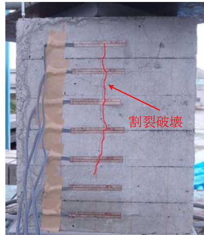
写真-1 割裂破壊状況
