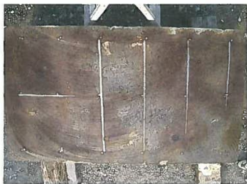
図-5 切断面 (2) の亜硝酸リチウム呈色反応状況 (圧入孔に垂直な断面)
