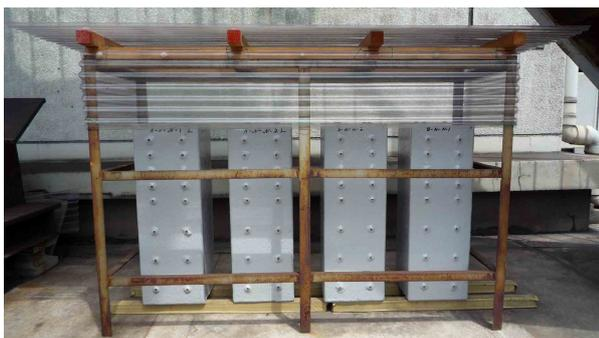
写真-2 屋外暴露状況 (無補修/雨掛無)
