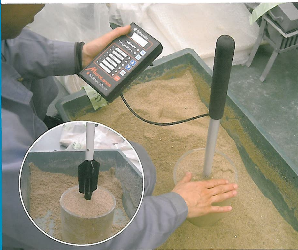
迅速簡易に細・粗骨材の表面水準を測定するマルイ製迅速骨材水分計「マイクロランス」
