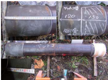
ヤットコ鋼管(連結部特殊加工)
