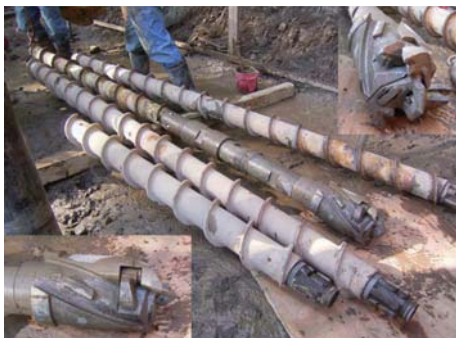
切削型拡張ビット(SMB-R)
