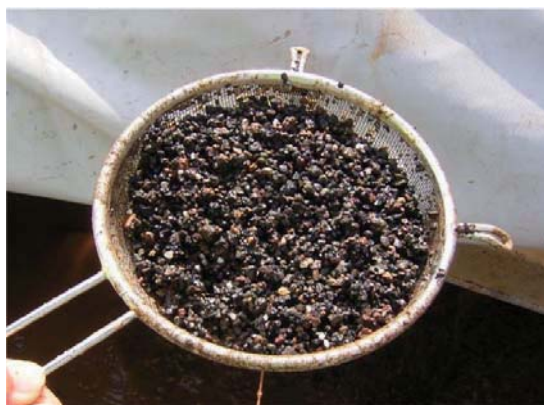
削孔スライム(砥川溶岩:輝石安山岩)
