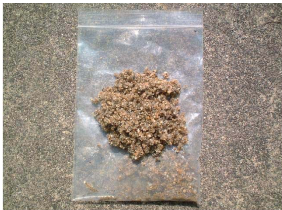
削孔スライム(マサ土)
