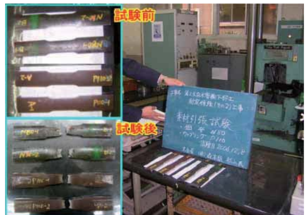
鋼管素材引張試験体
