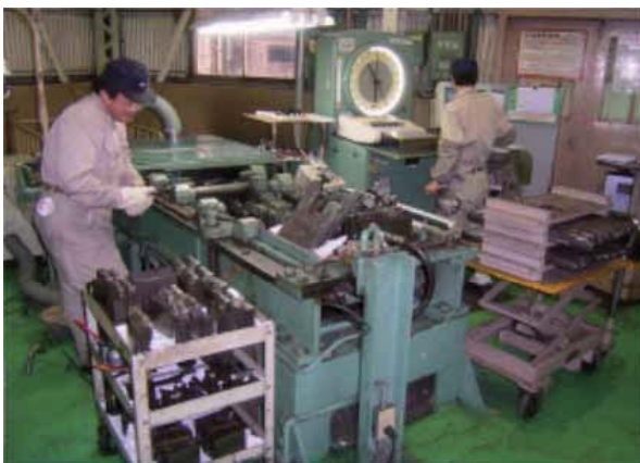
鋼管素材引張試験
