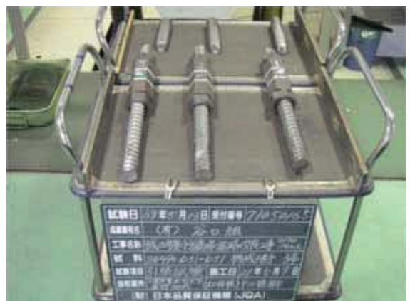
鉄筋引張試験(試験後)
