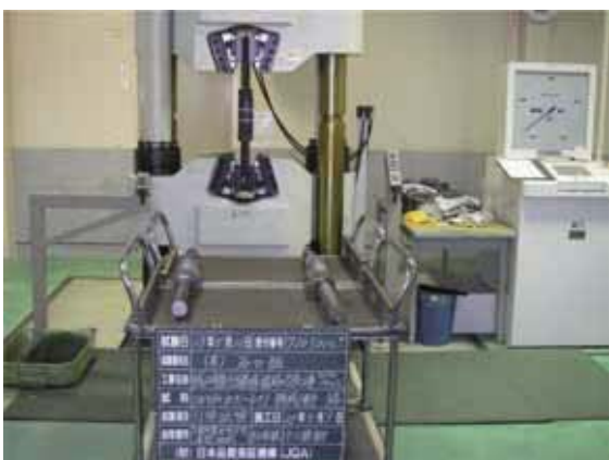
鉄筋引張試験(試験状況)
