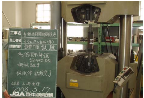
芯鉄筋引張試験状況 (カップラー接続品)
