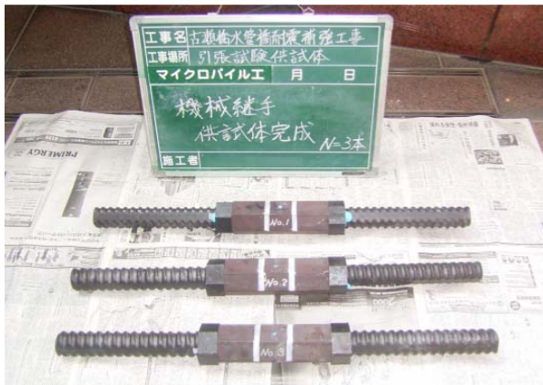
芯鉄筋引張試験供試体 (試験前)
