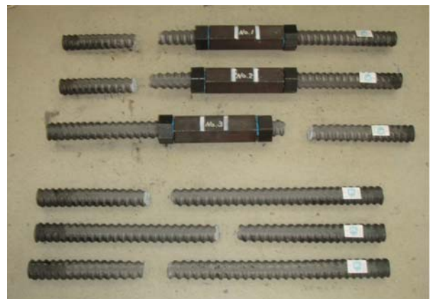
芯鉄筋引張試験供試体 (試験後)
