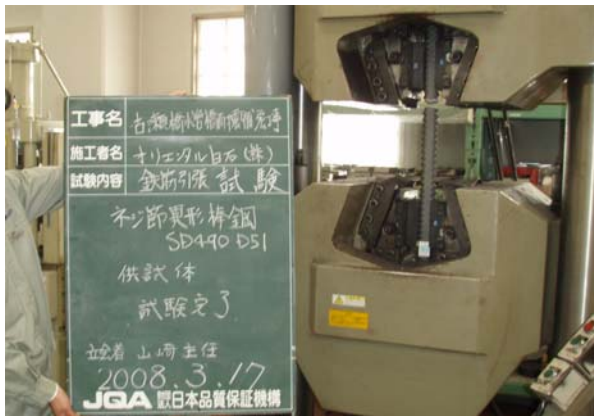
芯鉄筋引張試験状況 (棒鋼単体)
