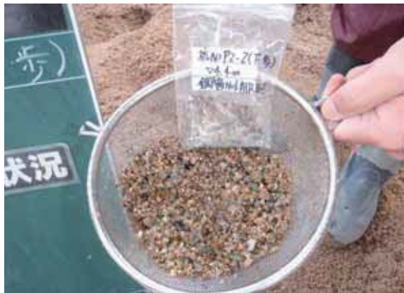
支持地盤の採取サンプル
