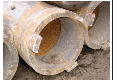
拡張ビット格納用突起加工
