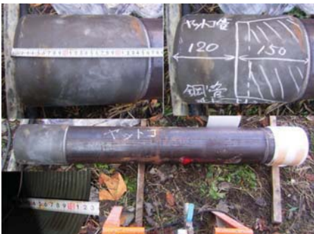
ヤットコ鋼管(連結部特殊加工)
