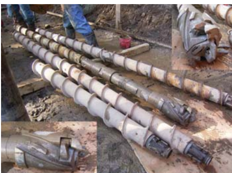
切削型拡張ビット(SMB-R)
