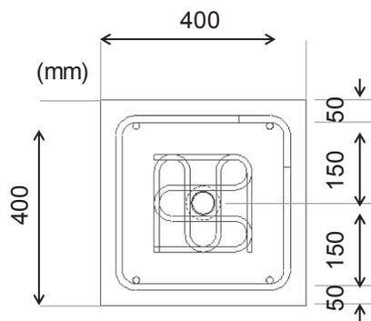
(d) Rebars arrangement -top view-
