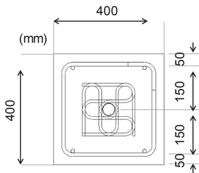
(d) Rebars arrangement -top view-
