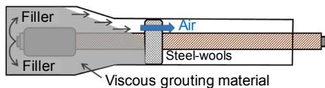
(d) Air-removal from the wedge-shaped hole
